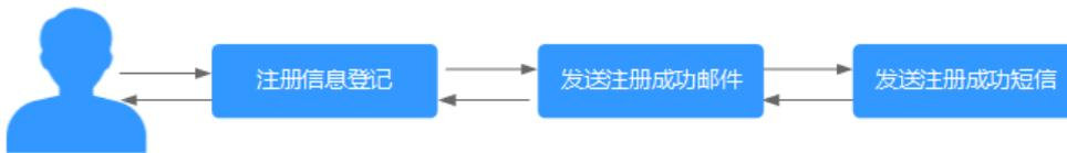
图1-2 借助消息队列异步发送注册邮件与短信流程
