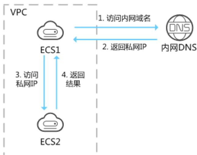
当 VPC 内云服务器访问内网域名时，内网 DNS 直接对内网域名进行解析，向云服务器返回对应被访问的云服务器器的私网 IP 地址。
